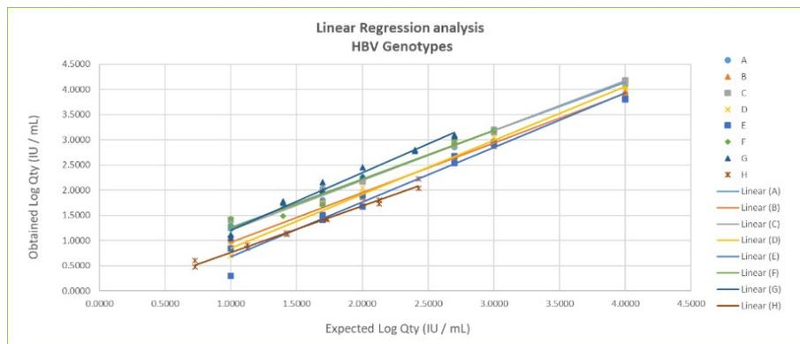
A linearidade do ensaio foi confirmada para os genótipos HBV principais (A, B, C, D, E, F, G) fornecendo resultados quantitativos dentro do intervalo  $\pm 0,5$  Log IU/mL e R2 de 0,979 a 0,996.
