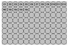
**Legende:** C1 - C12: Zu analysierende Proben; **NC**: Negative Amplifikationskontrolle; 10<sup>2</sup>: Standard 10<sup>2</sup> Kopien: 10<sup>3</sup>: Standard 10<sup>3</sup> Kopien: 10<sup>4</sup>: Standard 10<sup>4</sup> Kopien: 10<sup>5</sup>: Standard 10<sup>5</sup> Kopien.
