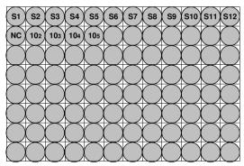
Legende: S1 - S12: Zu analysierende Proben; NC: Negativkontrolle der Amplifikation; 102: 102-Standardkopien; 103: 103-Standardkopien; 104: 104-Standardkopien; 105: 105-Standardkopien.
