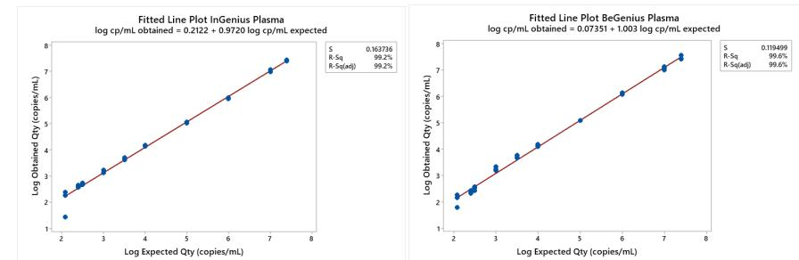
Die untere Quantifizierungsgrenze (LLOQ) wurde festgesetzt auf die LoD-Konzentration, bei der präzise (Standardabweichung =  $0,2529 \log$  Kopien/ml bei **ELITE InGenius** und  $0,2931 \log$  Kopien/ml bei **ELITE BeGenius**) und genaue (systematische Messabweichung =  $0,0503 \log$  Kopien/ml bei **ELITE InGenius** und  $0,0005 \log$  Kopien/ml bei **ELITE BeGenius**) quantitative Ergebnisse ausgegeben werden: 119 Kopien/ml.
