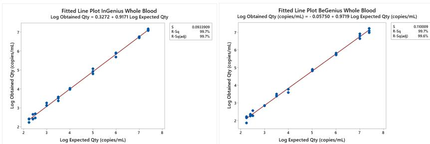
Die untere Quantifizierungsgrenze (LLOQ) wurde festgesetzt auf die LoD-Konzentration, bei der präzise (Standardabweichung =  $0,1081 \log$  Kopien/ml bei **ELITE InGenius** und  $0,1900 \log$  Kopien/ml bei **ELITE BeGenius**) und genaue (systematische Messabweichung =  $-0,1221 \log$  Kopien/ml bei **ELITE InGenius** und  $0,1591 \log$  Kopien/ml bei **ELITE BeGenius**) quantitative Ergebnisse ausgegeben werden: 171 Kopien/ml.
