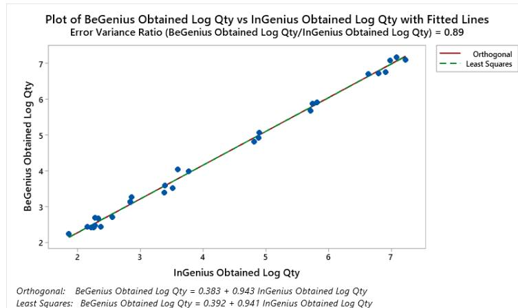
In diesem Test ergab die orthogonale Regressionsanalyse eine Steigung von 0,943 (95 %-KI: 0,919; 0,967) und einen Achsenabschnitt von 0,383 (95 %-KI: 0,276 bis 0,491). Die Analyse der linearen Regression ergab einen R2-Wert von 0,996.
