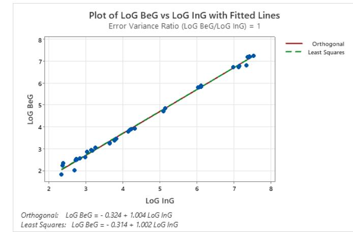
In diesem Test ergab die orthogonale Regressionsanalyse eine Steigung von 1,004 (95 %-KI: 0,9822–1,0267) und einen Achsenabschnitt von 0,324 (95 %-KI: -0,4334 bis -0,2147). Die Analyse der linearen Regression ergab einen R<sup>2</sup>-Wert von 0,995.
