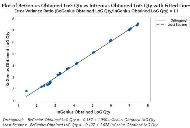
In diesem Test ergab die orthogonale Regressionsanalyse eine Steigung von 1,030 (95 %-KI: 1,005; 1,056) und einen Achsenabschnitt von -0,137 (95 %-KI: -0,257; -0,017). Die Analyse der linearen Regression ergab einen R<sup>2</sup>-Wert von 0,996.
