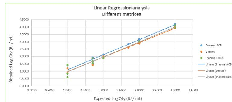
A linearidade do ensaio foi confirmada para o plasma em ACD e soro, fornecendo resultados quantitativos dentro do intervalo de  $\pm 0,5$  Log IU/mL e um R2 de 0,982 e 0,988, respetivamente.
