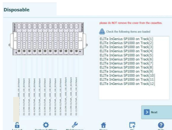
Figura 8: La schermata “Disposable” (Materiale Monouso) è usata per confermare il caricamento dell'Extraction Rack.
