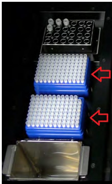
Figura 5-57 Posicionamento no instrumento das pontas individuais do gestor de reagente do instrumento.
