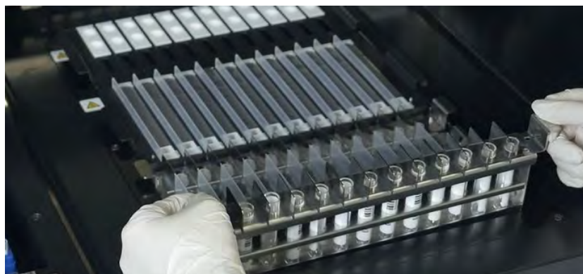
Figura 5-78: Exemplo carregamento do suporte do tubo primário no instrumento.
