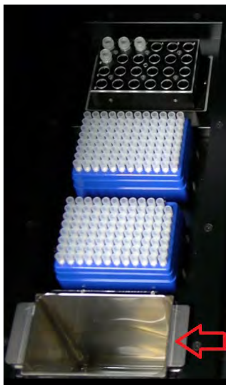
Figura 5-41: Posicionamento do recipiente para resíduos no instrumento.
