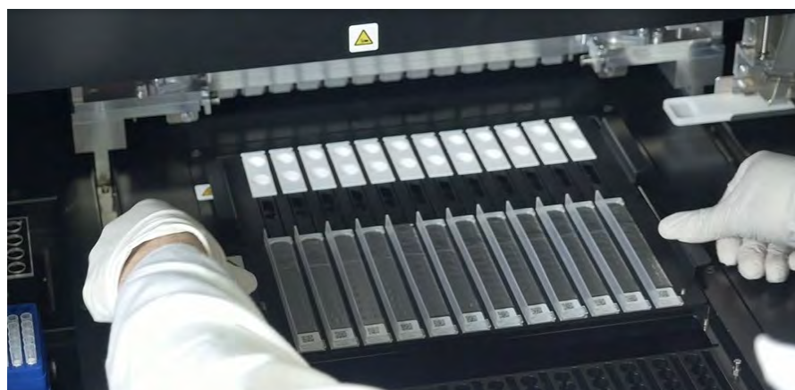
Figura 5-63: Carregamento do suporte das caixas de extração.
