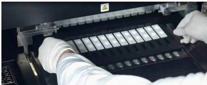
Figura 5-61: Carregamento do suporte do cassete de PCR
