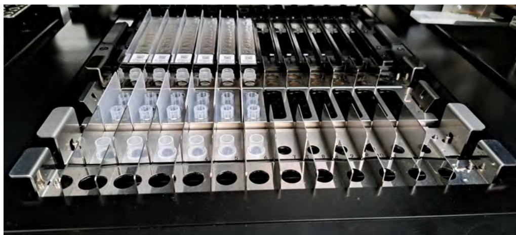
Figura 5-76 : Exemplo de colocação do tubo de extração no rack do tubo de extração.
