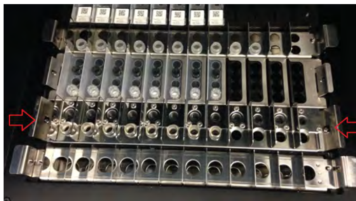
Figura 5-74: Rimozione del rack di sonicazione.
