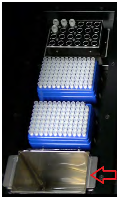
Figura 5-41: Posizionamento del contenitore per rifiuti sullo strumento.
