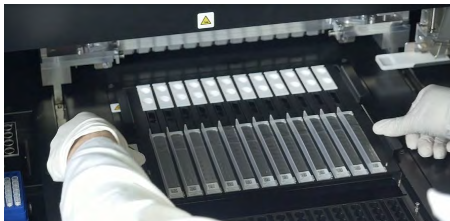
Figura 5-63: Caricamento del rack con le Extraction cassette.
