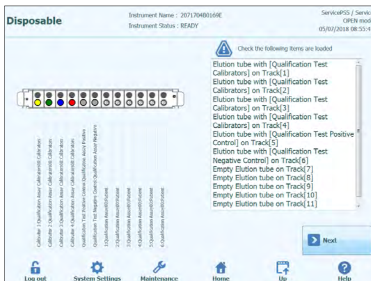
Figura 5-68: Indicazioni per il caricamento Elution Tube (posizione 1)
