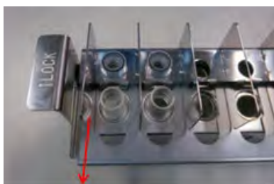
Rilascio del bloccaggio provette nel rack
