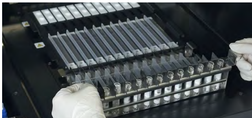
Figura 5-78: Esempio di caricamento del rack Primary Tube sullo strumento.
