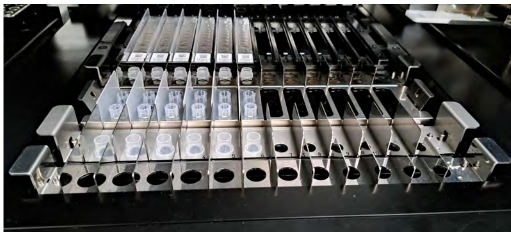
Figura 5-76: Esempio di posizionamento di provetta di estrazione (fondo) sullo strumento.
