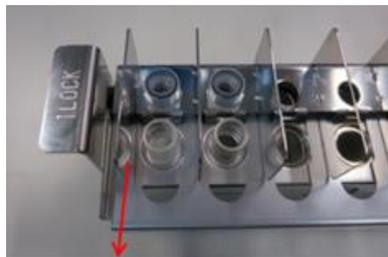
Rilascio del bloccaggio provette nel rack
