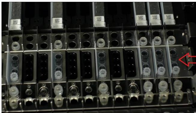
Figura 5-71: Caricamento dei puntali nello strumento.
