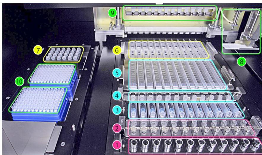
Figura 1.2: Strumento ELITE InGenius – Vista area di lavoro
