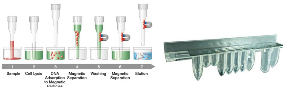
Figura 1.4: Principio di estrazione dell'acido nucleico e cassetta di estrazione ELITE InGenius SP 1000
