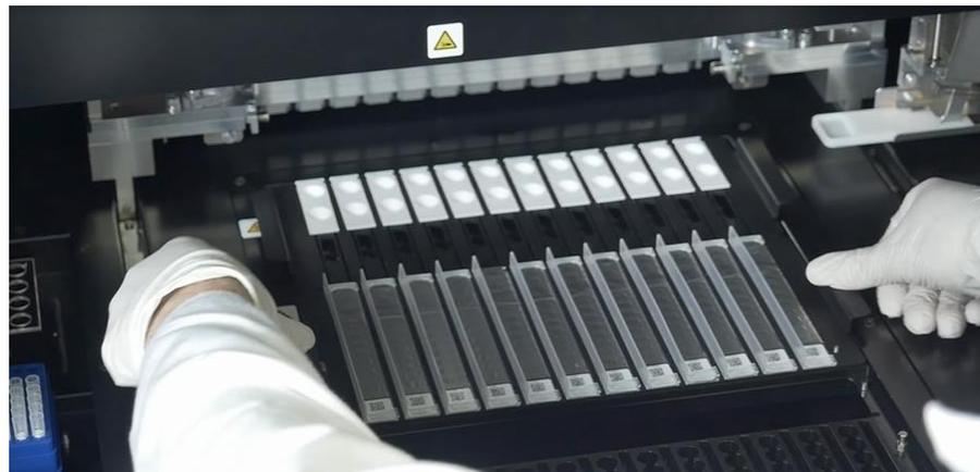
Figura 5-63: Caricamento del rack con le Extraction cassette.
