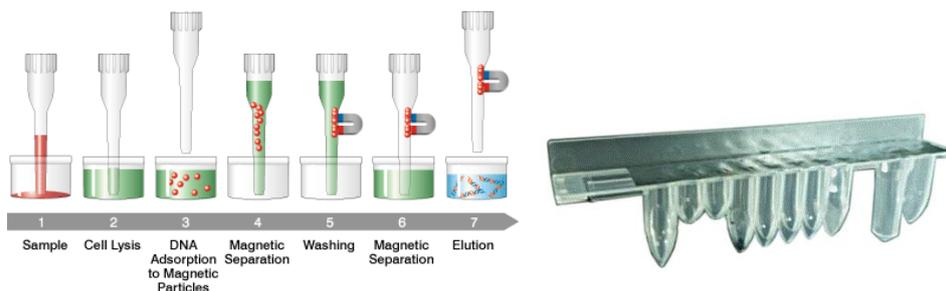
Figura 1.3: Principio di estrazione degli acidi nucleici e cartuccia di estrazione ELITE InGenius SP 200
