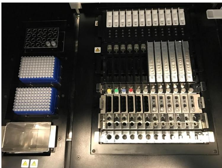
*Figura 5-79: Esempio di configurazione finale dello strumento. In questa immagine è rappresentata una configurazione di sessione analitica che comprende: 5 campioni in provetta primaria, 6 Extraction Cassette, 12 PCR Cassette.*
