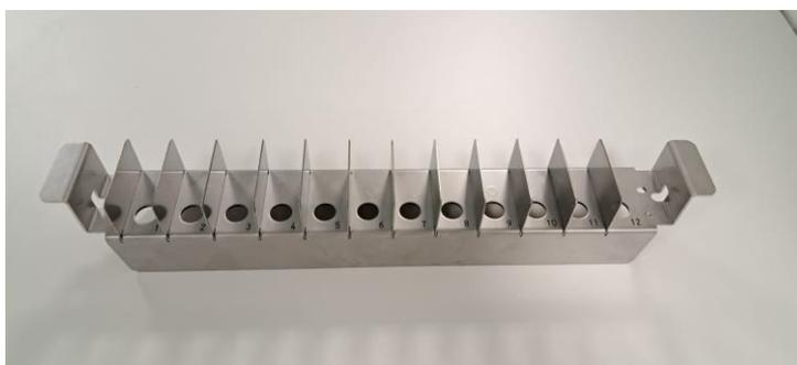
Figure 5-73: Rack per l'Estrazione.
