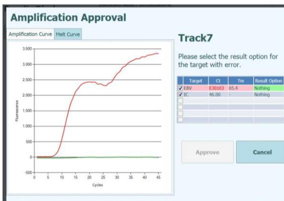
Figura 5-100: Approvazione di un campione con errore 30103.
