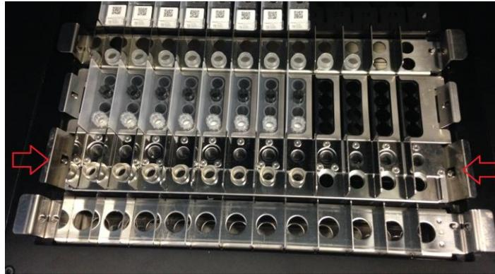
Figura 5-74: Rimozione del rack di sonicazione.
