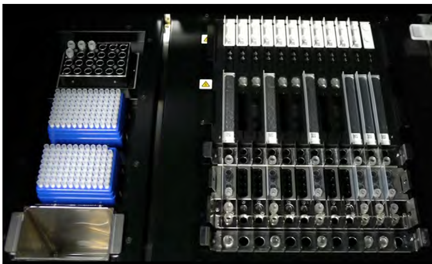
Figura 5-79: Exemplo de configuração final do instrumento. Nesta figura está representada uma configuração de sessão analítica que inclui: 5 amostras primárias, 6 caixas de extração, 12 caixas de PCR.
