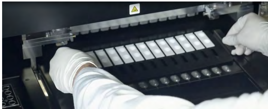
Figura 5-61: Carregamento do suporte do cassete de PCR
