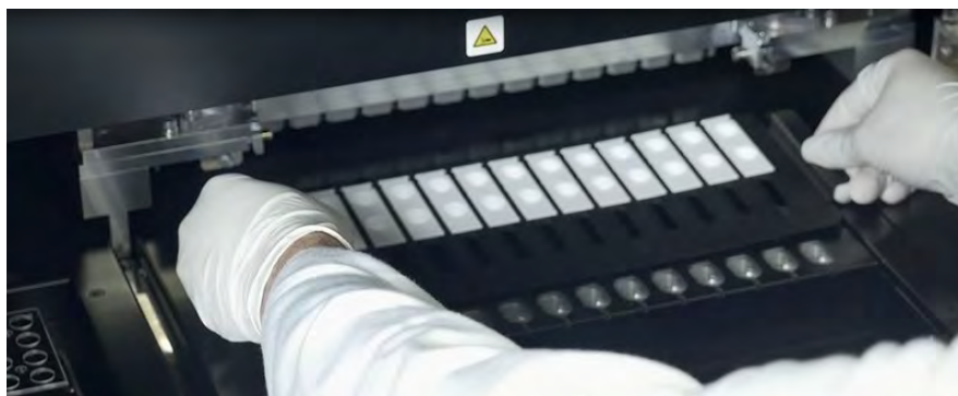
Figura 5-61: Caricamento rack con le PCR cassette
