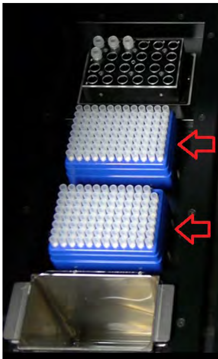
Figura 5-57: Posizionamento di puntali singoli nell'area di gestione scorte dello strumento.
