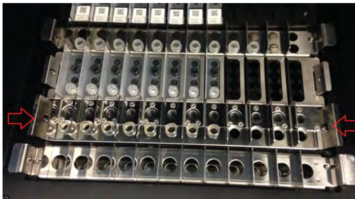
Figura 5-74: Rimozione del rack di sonicazione.
