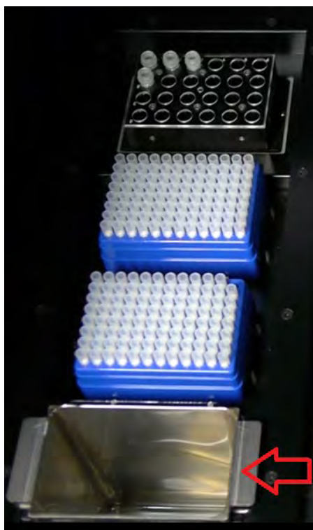
Figura 5-41: Posizionamento del contenitore per rifiuti sullo strumento.
