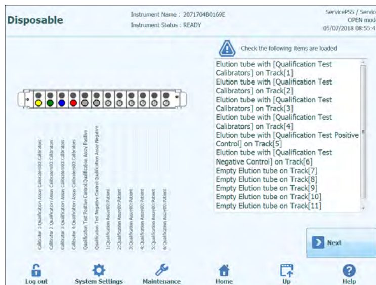
Figura 5-68: Indicazioni per il caricamento Elution Tube (posizione 1)
