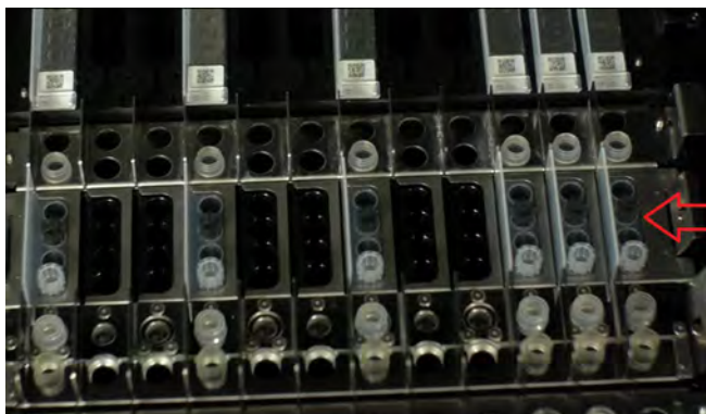
Figura 5-71: Caricamento dei puntali nello strumento.
