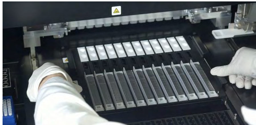
Figure 5-63: Chargement du compartiment à cassettes d'extraction
