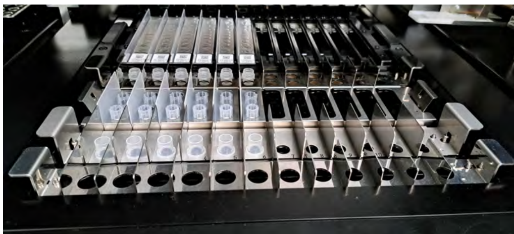
Figure 5-76: exemple de positionnement de tubes d'extraction dans le portoir de tubes d'extraction.
