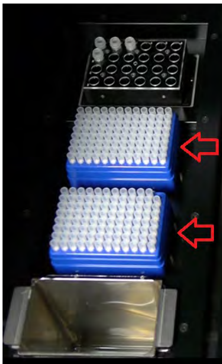
Figure 5-57 Mise en place des embouts dans l'instrument.
