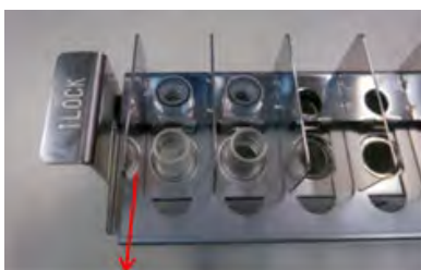
Libération du verrou d'un tube de sonication du portoir
