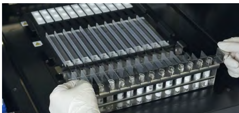
Figure 5-78: Exemple de chargement des tubes primaires sur l'instrument.
