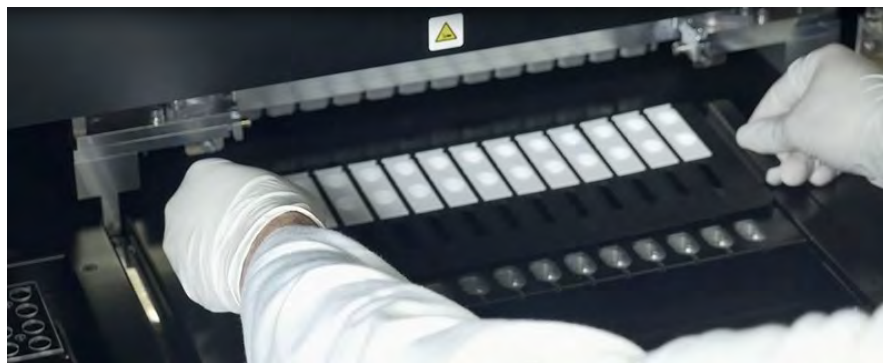
Figure 5-61: Chargement du compartiment à cassettes PCR
