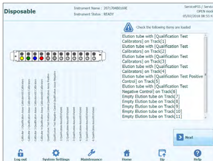
Figure 5-68: Aide au chargement de tubes supplémentaires (position 1).
