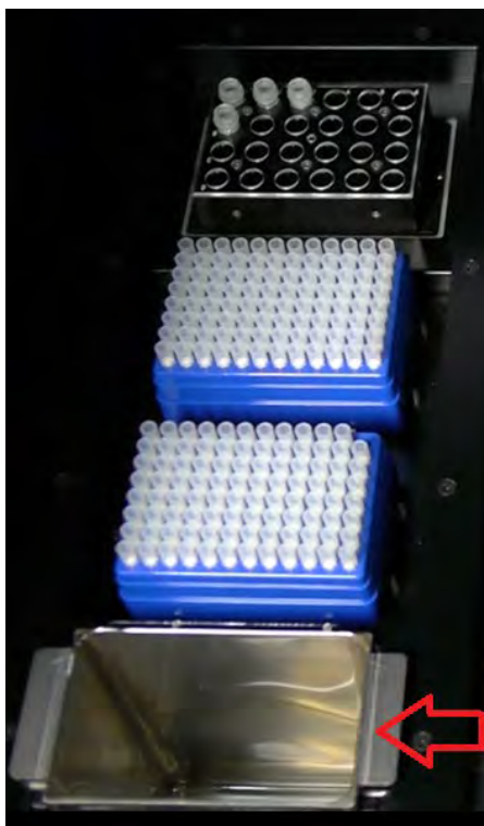
Figure 5-41: Emplacement du conteneur à déchets sur l'instrument.
