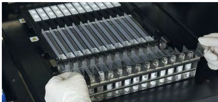
Figura 5-78: Ejemplo de carga de rack Tubo primario en el instrumento.
