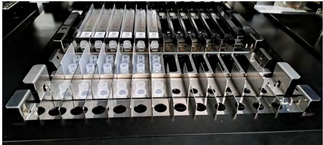
Figura 5-76: Ejemplo de colocación de la probeta de extracción en la gradilla para probetas de extracción.
