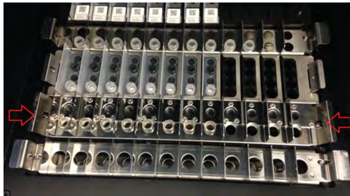
Figura 5-74: Retiro del rack de extracción
