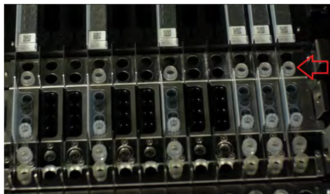
Figura 5-69: Carga de rack de Tubos Extras en el instrumento. Los tubos de elución se colocan en la posición 1, que es la más cercana al frente del instrumento
