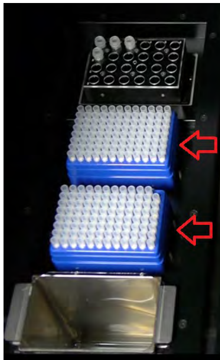
Figura 5-57 Colocación de las puntas únicas en el administrador de inventarios del instrumento.
