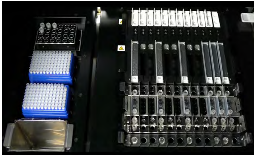
Figura 5-79: Ejemplo de la configuración final del instrumento. En esta imagen se representa una configuración de la ejecución que incluye: 5 muestras en tubo primario, 6 contenedores de extracción, 12 contenedores PCR.
