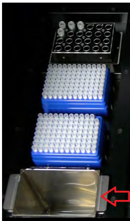
Figura 5-41: Colocación del contenedor de desechos en el instrumento.
