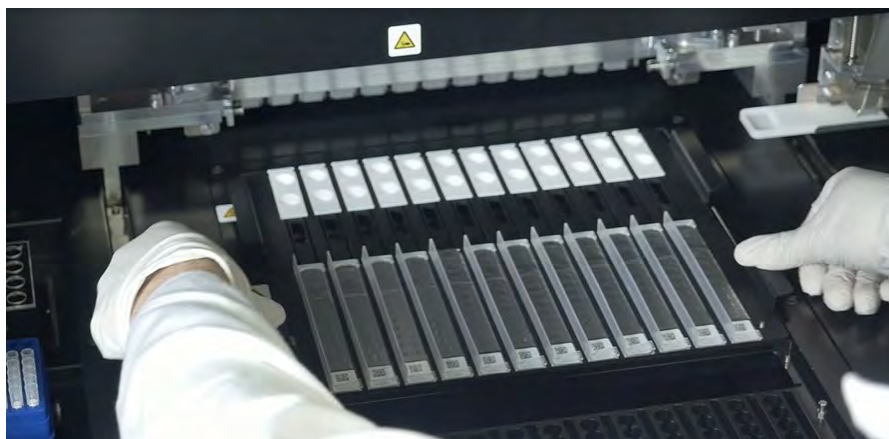
Abb. 5-63: Laden des Extraktionskassettenständers auf das Gerät
