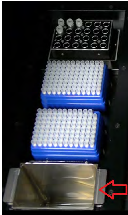
Abb. 5-41: Aufstellung des Abfallbehälters am Gerät
