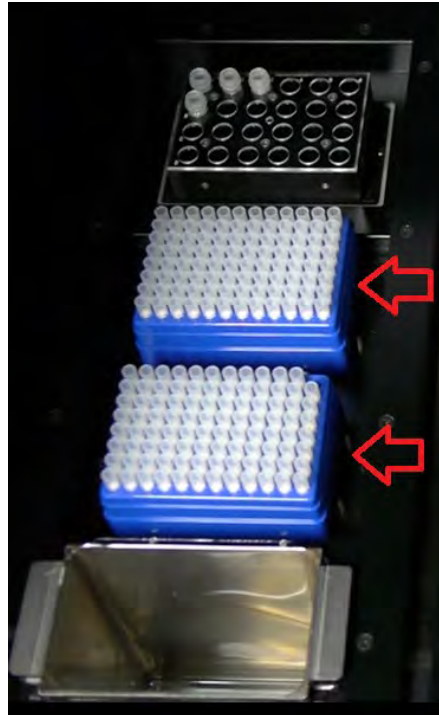
Abb. 5-57: Einstellen der Bestandsmanager-Einzelspitzen in das Gerät
