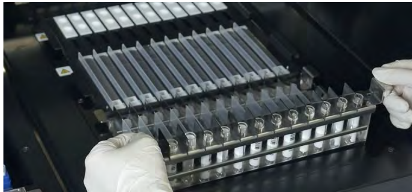
Abb. 5-78: Beispiel für das Einstellen der Primärröhrchen in das Gerät
