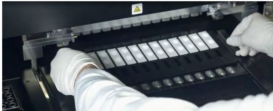
Abb. 5-61: Laden des PCR-Kassettenständers auf das Gerät
