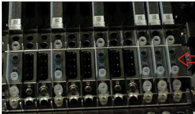
Abb. 5-71: Laden der Pipettenspitzen auf das Gerät
