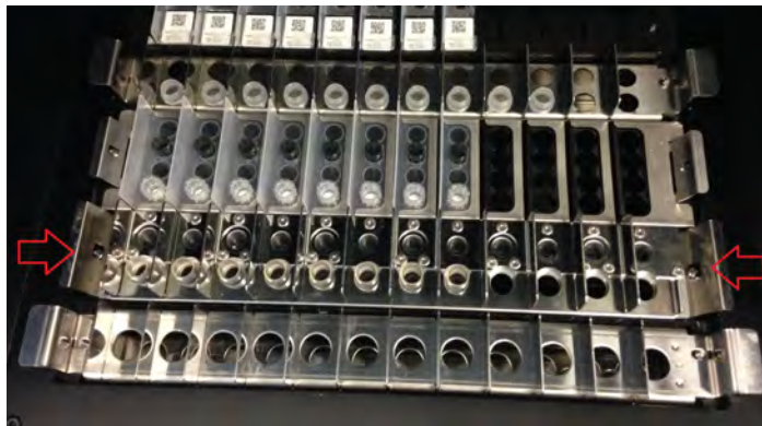
Abb. 5-74: Entnahme des Ultraschallracks
