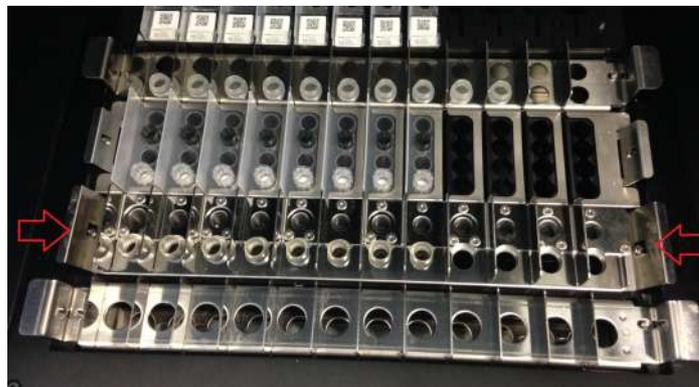
Figura 5-72: Remoção do suporte de extracção
