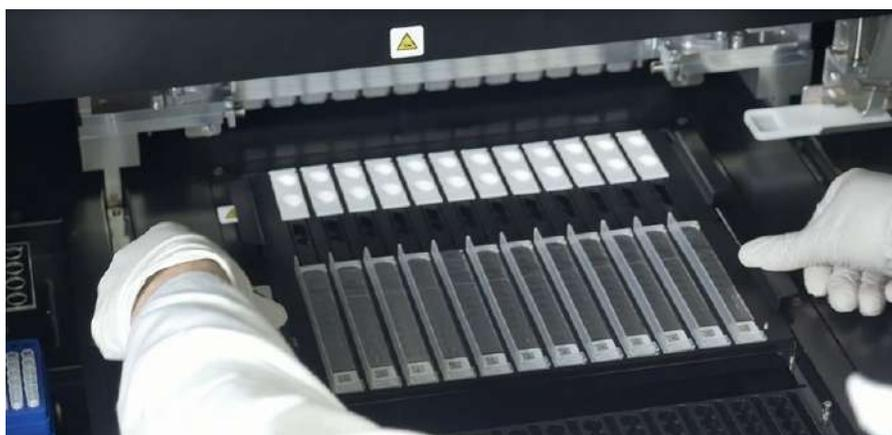
Figura 5-63 Carregamento do suporte das caixas de extração.
