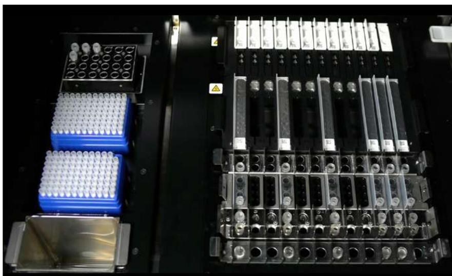
Figura 5-77: Exemplo de configuração final do instrumento. Nesta figura está representada uma configuração de sessão analítica que inclui: 5 amostras primárias, 6 caixas de extração, 12 caixas de PCR.
