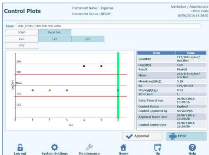
Figura 5-13: Gráfico de controle - Painel do diagrama.
