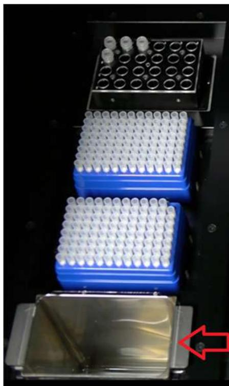
Figura 5-41: Posicionamento do recipiente para resíduos no instrumento.
