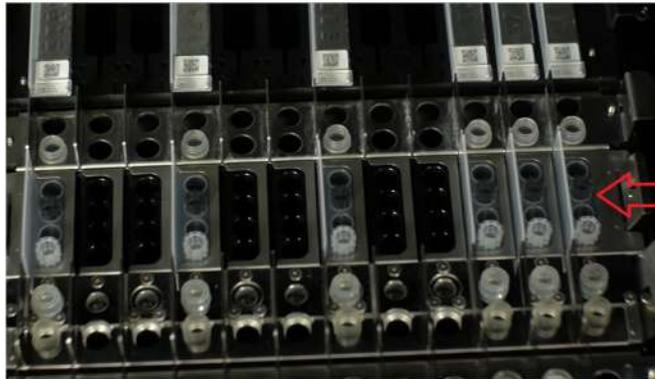
Figura 5-71: Carregando de pontas no Instrumento
