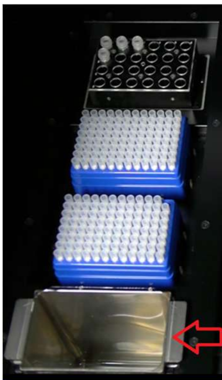
Figure 5-41: Emplacement du conteneur à déchets sur l'instrument.
