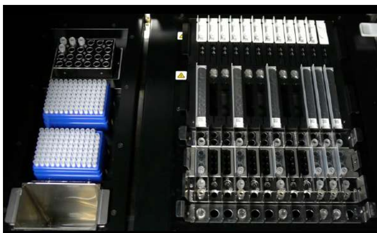
Figure 5-77: Exemple de configuration finale de l'instrument. Cette figure représente une configuration de cycle d'analyse comprenant : 5 échantillons primaires, 6 cassettes d'extraction, 12 cassettes d'amplification.
