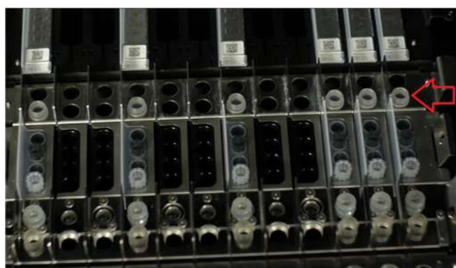
Figure 5-69: Chargement du compartiment de tubes supplémentaires sur l'instrument. Les tubes d'éluion sont placés dans l'emplacement 1, le plus proche de la façade de l'instrument
