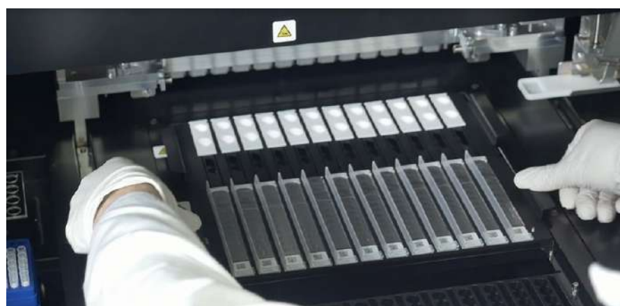
Figure 5-63: Chargement du compartiment à cassettes d'extraction
