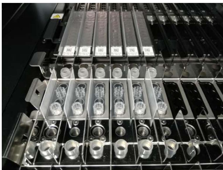
Figure 5-74 : Exemple de mise en place d'un tube de sonication (en bas) et d'un bouchon (en haut) sur l'instrument
