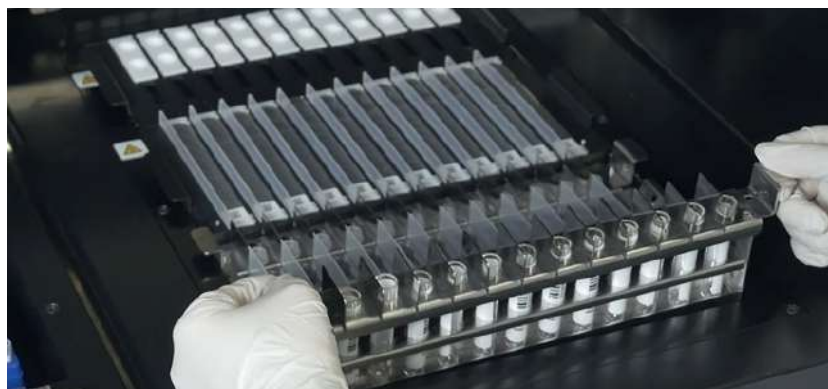
Figure 5-76: Exemple de chargement des tubes primaires sur l'instrument.
