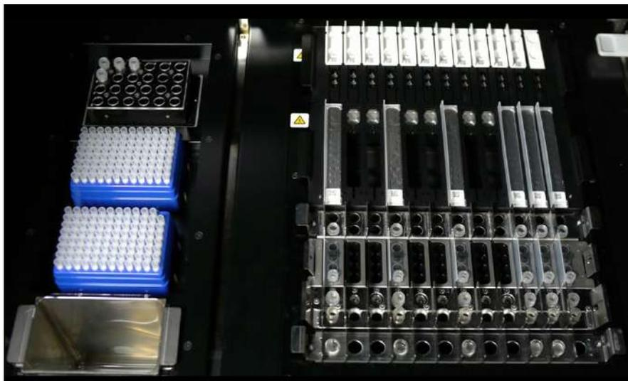
Figura 5-77: Ejemplo de la configuración final del instrumento. En esta imagen se representa una configuración de la ejecución que incluye: 5 muestras en tubo primario, 6 contenedores de extracción, 12 contenedores PCR.
