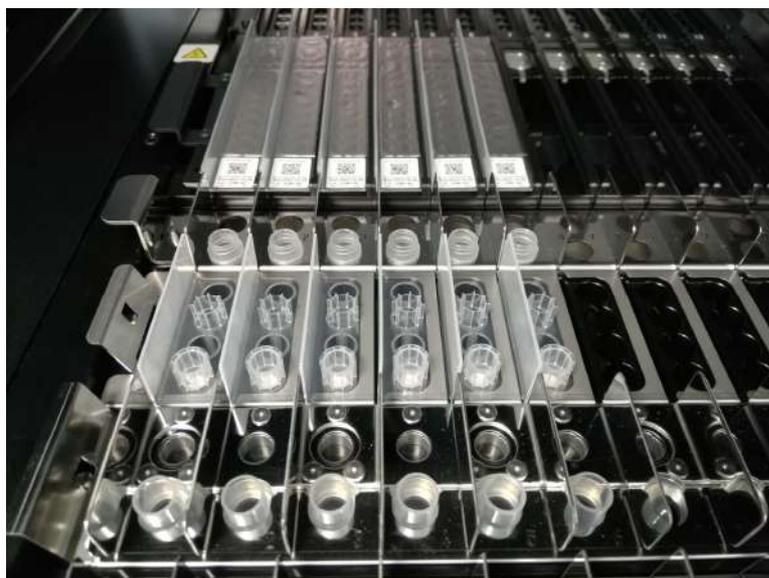
Figura 5-74: Ejemplo de colocación de tubo sonicador (parte inferior) y tapa (parte superior) en el instrumento
