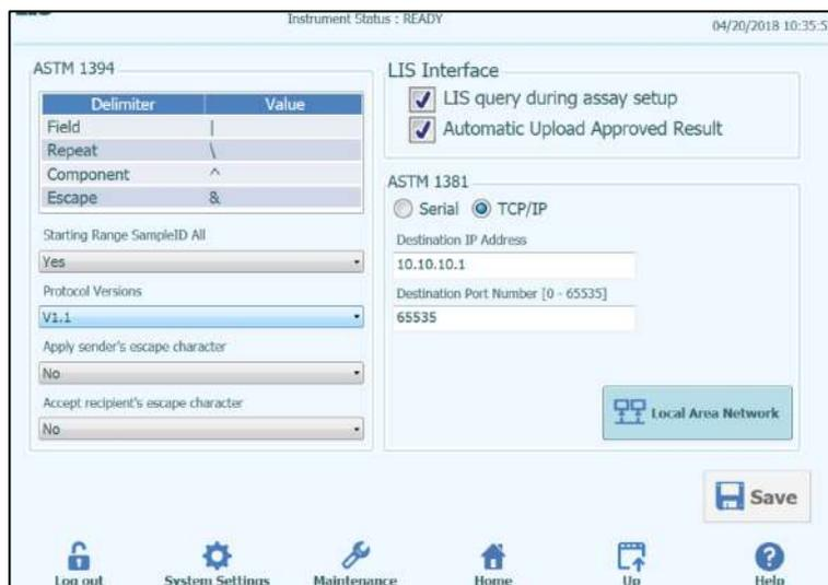
Figura 6-11: Configuración TCP/IP
