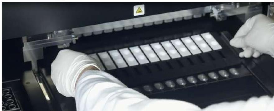
Figura 5-61: Carga de rack con los contenedores PCR
