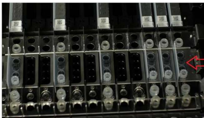
Figura 5-71: Carga de puntas en el instrumento.
