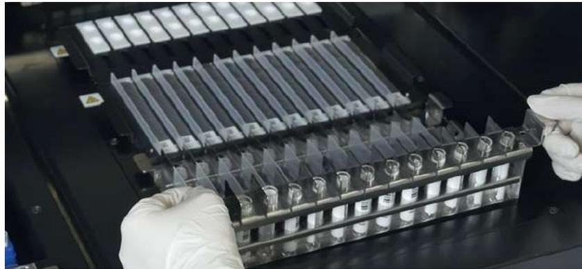
Figura 5-76: Ejemplo de carga de rack Tubo primario en el instrumento.
