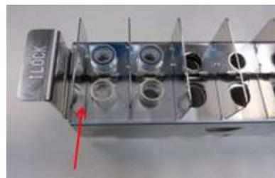
Activación del bloqueo del Tubo
