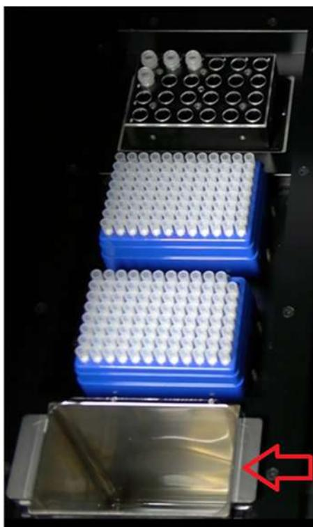
Figura 5-41: Colocación del contenedor de desechos en el instrumento.
