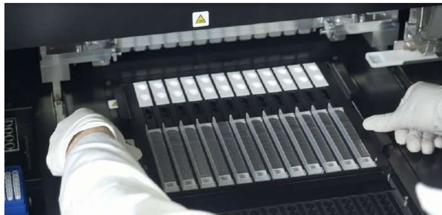
Abb. 5-57: Laden des Extraktionskassettenständers auf das Gerät
