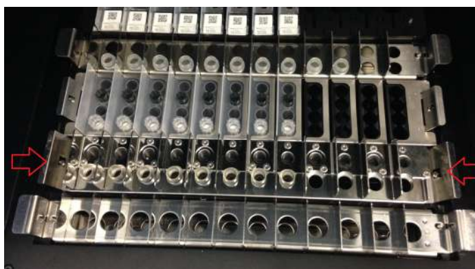
Abb. 5-60: Entnahme des Ultraschallständers
