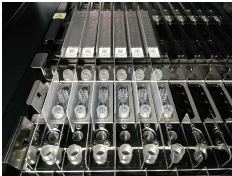
Abb. 5-74: Beispiel für das Einsetzen von Ultraschallröhrchen (unten) und Deckeln (oben) in das Gerät
