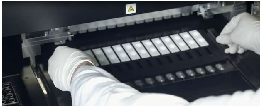
Abb. 5-55: Laden des PCR-Kassettenständers auf das Gerät
