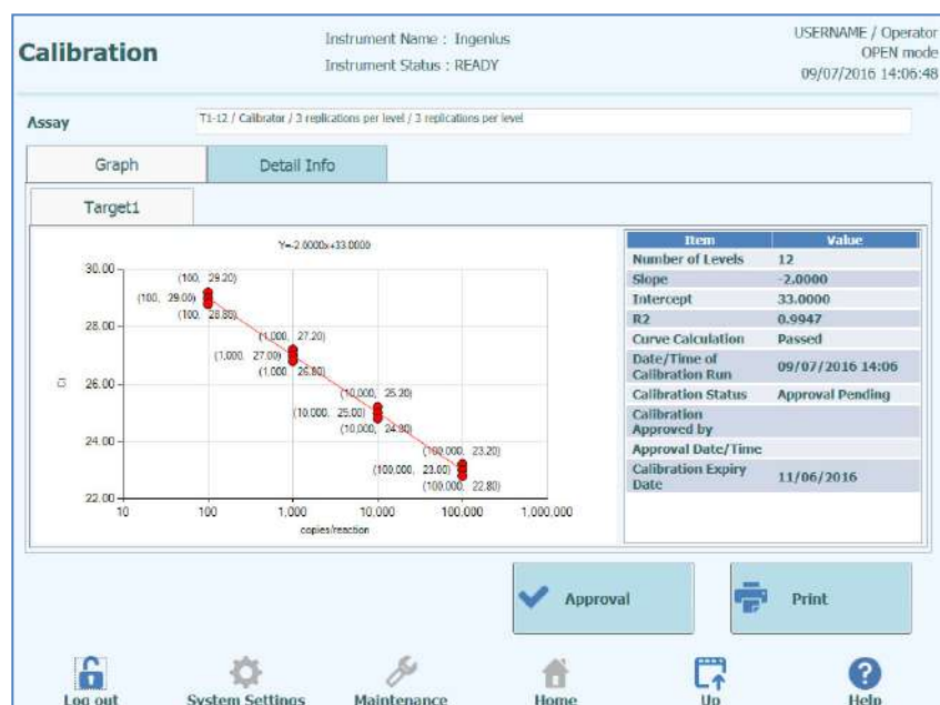
Abb. 5-72: Bildschirm „Calibration“ – Standardkurve mit Replikaten
