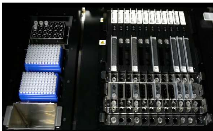
Abb. 5-77: Beispiel für die abschließende Konfiguration des Geräts. Diese Abbildung zeigt eine Laufkonfiguration mit: 5 Primärproben, 5 Extraktionskassetten, 12 Amplifikationskassetten.
