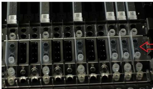
Abb. 5-71: Laden der Pipettenspitzen auf das Gerät
