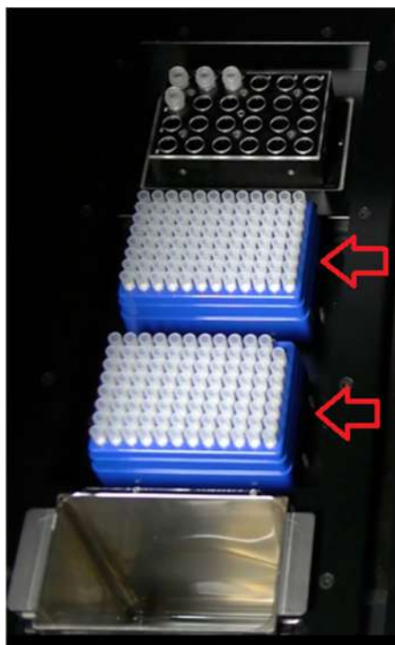
Abb. 5-51: Einstellen der Bestandsmanager-Einzelspitzen in das Gerät
