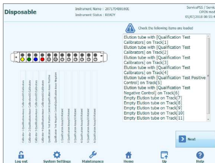
Abb. 5-58: Angaben zum Laden eines Extraröhrchens (Position 1)
