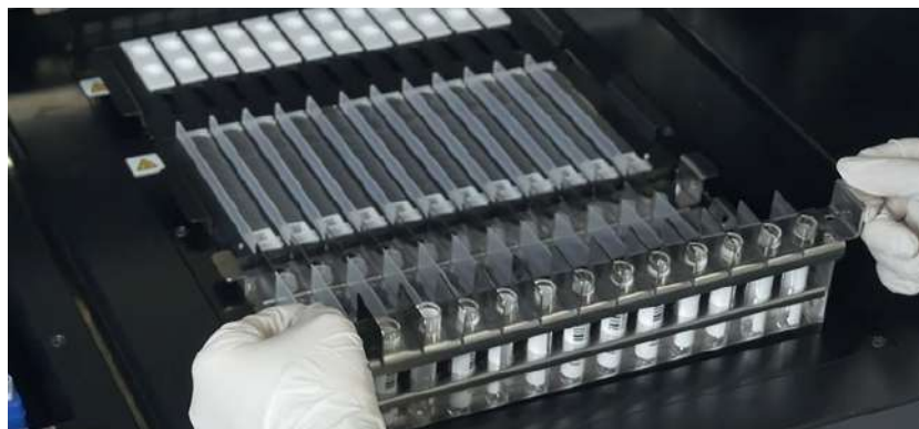
Abb. 5-62: Beispiel für das Einstellen der Primärröhrchen in das Gerät
