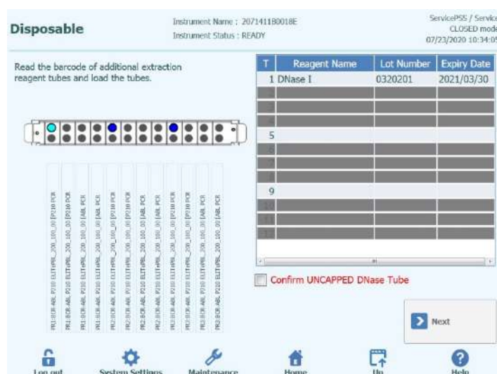
Abbildung 5-67: Anleitungen zum Laden von DNase I nach dem Einlesen
