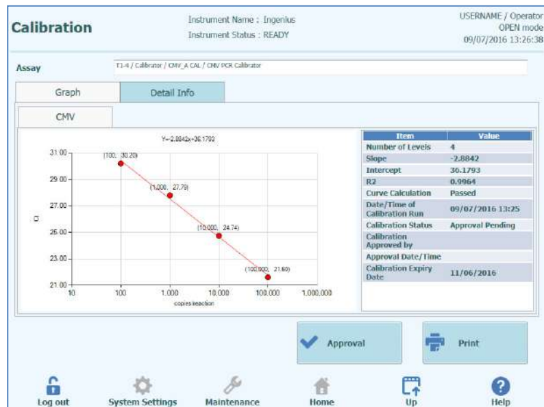
Abb. 5-70: Bildschirm „Calibration“ – Standardkurve
