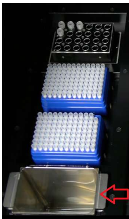
Abb. 5-36: Aufstellung des Abfallbehälters am Gerät
