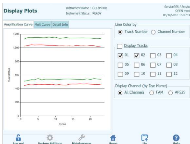
Abb. 5-81: Anzeige von Diagrammen während eines Laufs: Amplifikationskurven
