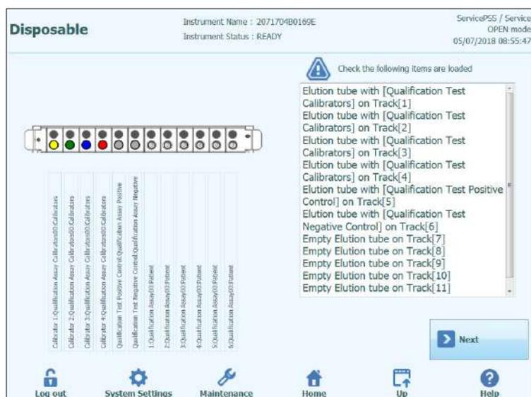
Figura 5-68: Indicazioni per il caricamento Elution Tube (posizione 1)
