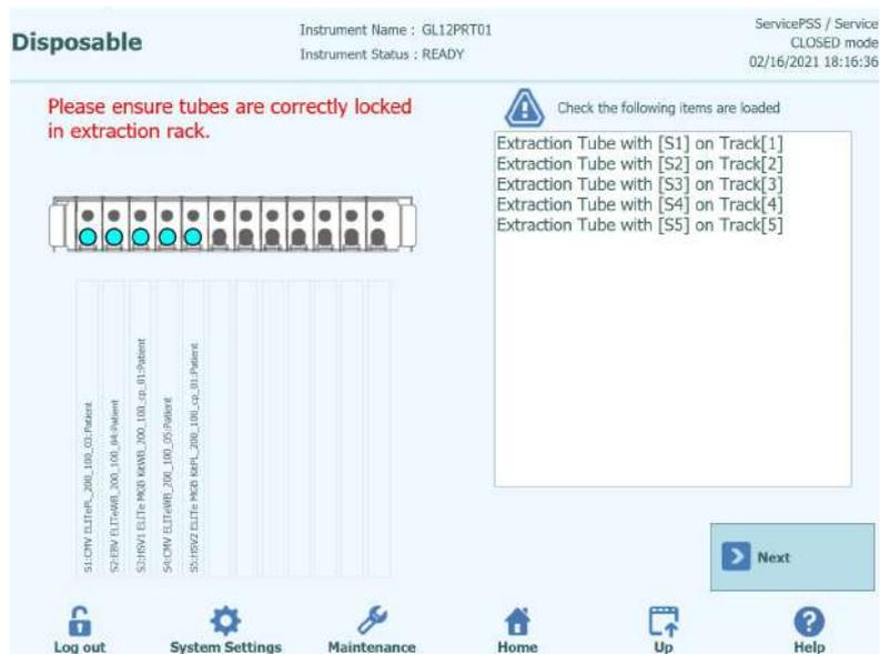
Figura 5-73: Indicazioni per il caricamento dei tubi di estrazione.
