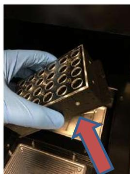
2) Utilizzando un panno o un tovagliolo di carta asciugare completamente il blocco freddo e la superficie di lavoro come mostrato di seguito.
