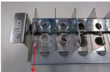
Rilascio del bloccaggio provette nel rack
