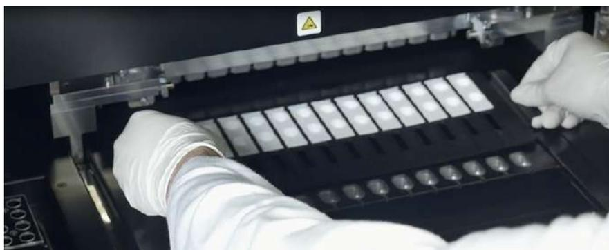
Figura 5-61: Caricamento rack con le PCR cassette
