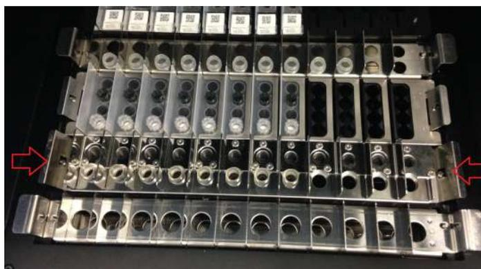
Figura 5-72: Rimozione del rack di estrazione
