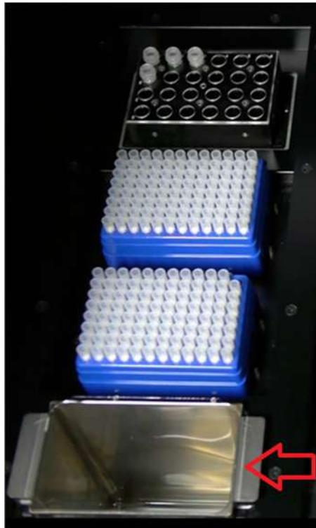
Figura 5-41: Posizionamento del contenitore per rifiuti sullo strumento.
