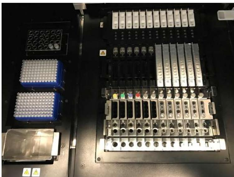
Figura 5-77: Esempio di configurazione finale dello strumento. In questa immagine è rappresentata una configurazione di sessione analitica che comprende: 5 campioni in provetta primaria, 6 Extraction Cassette, 12 PCR Cassette.
