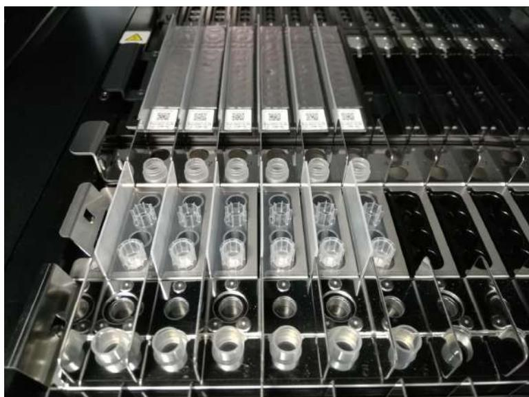
Figura 5-74: Esempio di posizionamento di provetta di sonicazione (fondo) e tappo (parte superiore) sullo strumento
