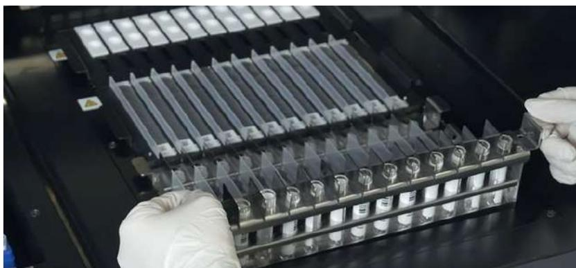
Figura 5-76: Esempio di caricamento del rack Primary Tube sullo strumento.
