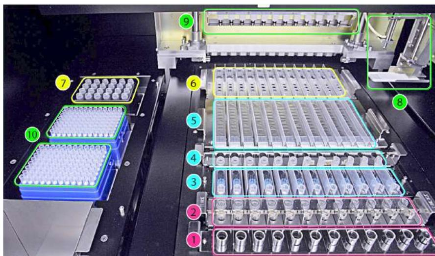
Figura 1.2: Strumento ELITE InGenius – Vista area di lavoro
