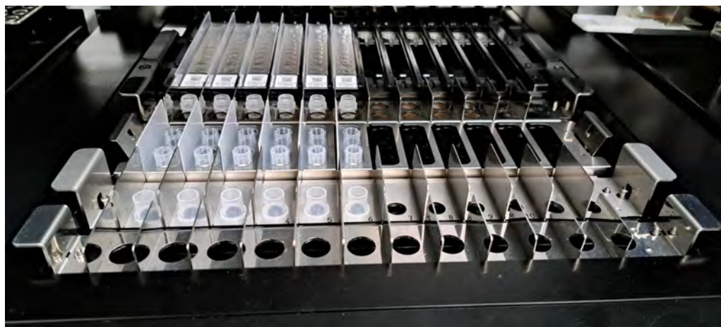
Figura 5-80: Esempio di posizionamento di provetta di estrazione (fondo) sullo strumento.
