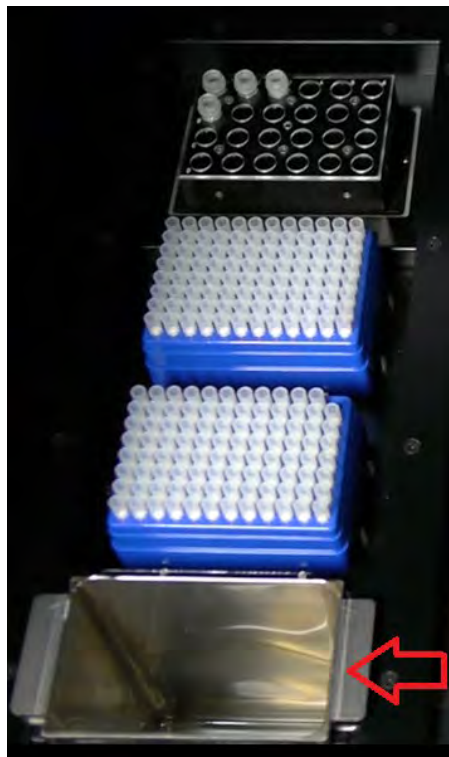
Figura 5-45: Posizionamento del contenitore per rifiuti sullo strumento.
