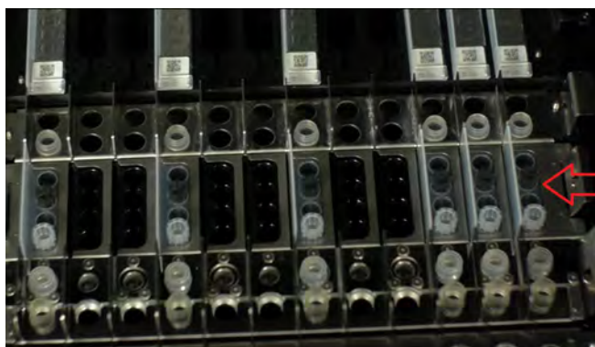
Figura 5-75: Caricamento dei puntali nello strumento.
