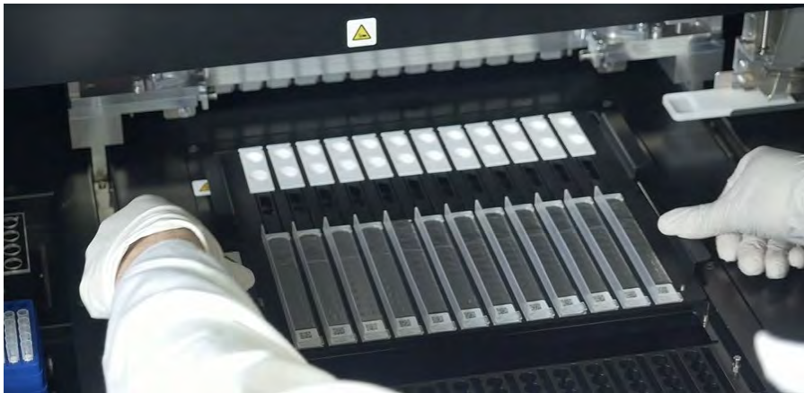
Figure 5-67: Chargement du compartiment à cassettes d'extraction
