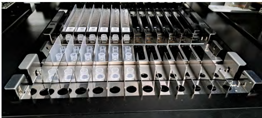
Figure 5-80: exemple de positionnement de tubes d'extraction dans le portoir de tubes d'extraction.
