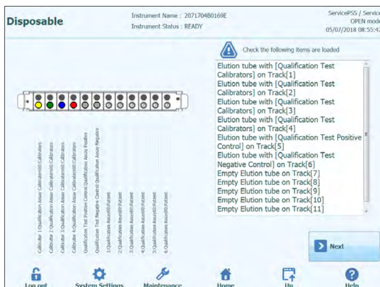
Figura 5-72: Guía de carga de Tubos Extras (posición 1).
