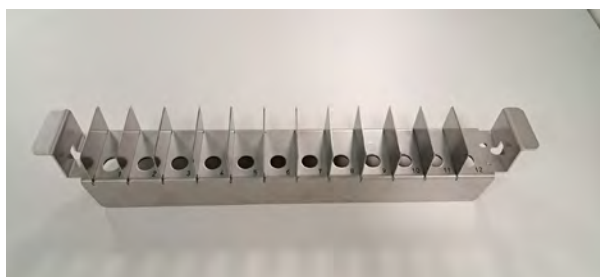
Figura 5-77. Gradilla para probetas de extracción
