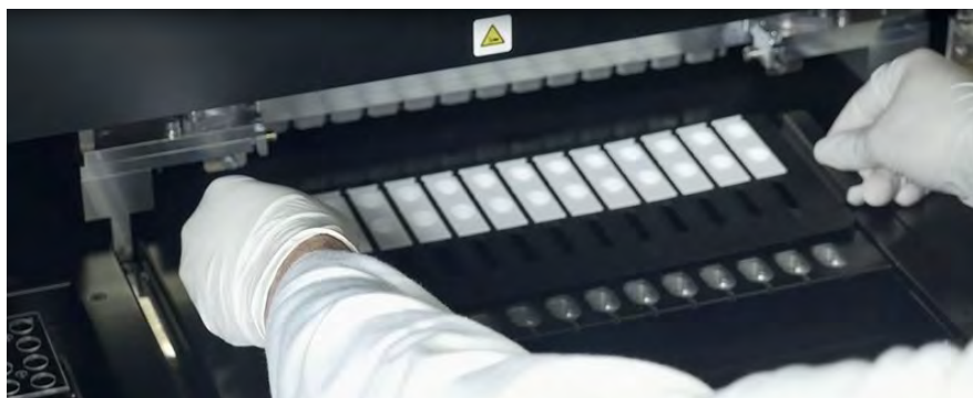
Figura 5-65: Carga de rack con los contenedores PCR
