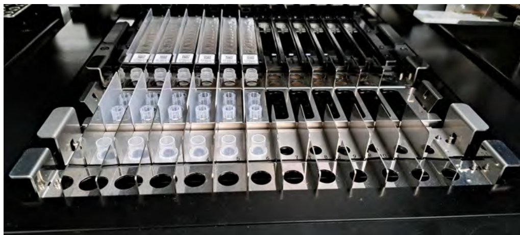
Figura 5-80: Ejemplo de colocación de la probeta de extracción en la gradilla para probetas de extracción.
