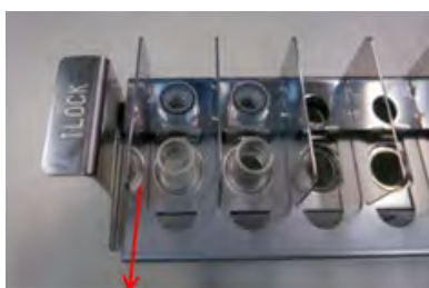
Liberación del bloqueo de la probeta de ultrasonidos de la gradilla
