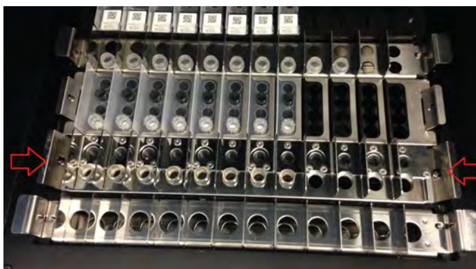
Figura 5-78: Retiro del rack de extracción
