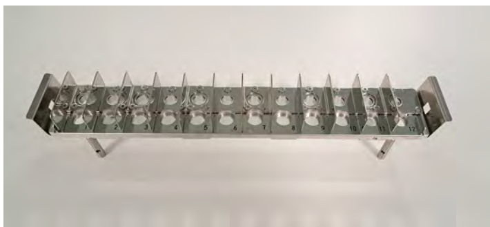
Figura 5-76. Gradilla para probetas de ultrasonidos
