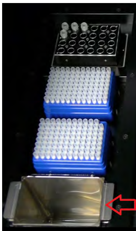
Figura 5-45: Colocación del contenedor de desechos en el instrumento.
