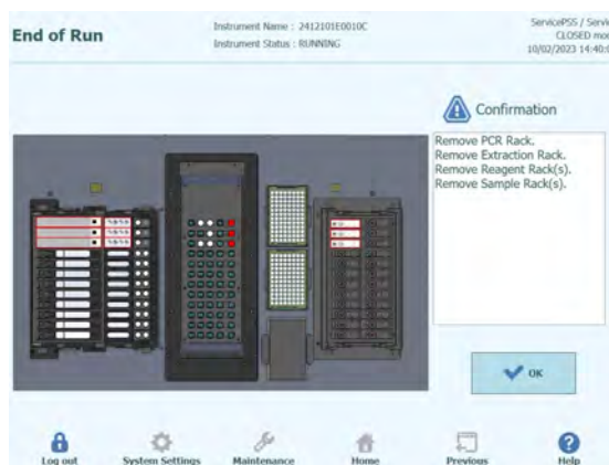
Figura 5-211: Ecrã de fim de execução com instruções sobre como descarregar, guardar ou eliminar as amostras, os materiais e os reagentes
