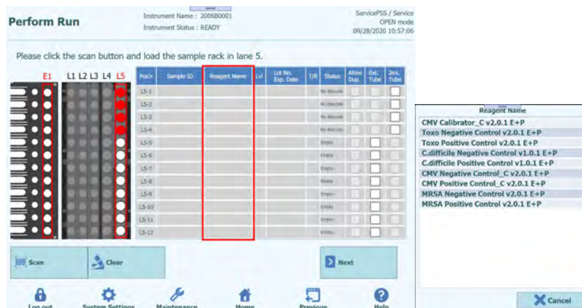
Figura 5-147: Seleção do reagente a partir da coluna "Reagent Name" (Nome do reagente)
