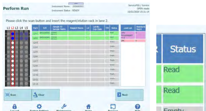
Figura 5-130: Estado de "Read" (Lido) para um tubo de eluição com código de barras corretamente lido
