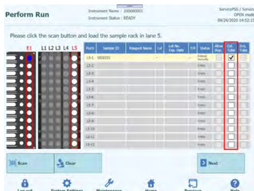
Figura 5-46: Verificação do tubo de extração
