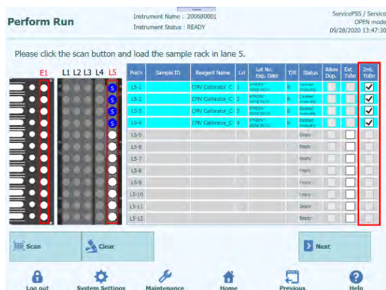
Figura 5-156: Verificação do tubo de 2 mL em caso de tubo do calibrador de 2 mL
