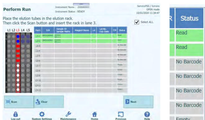
Figura 5-110: Estado "No Barcode" (Nenhum código de barras) quando não está apensa nenhuma etiqueta no tubo de calibração
