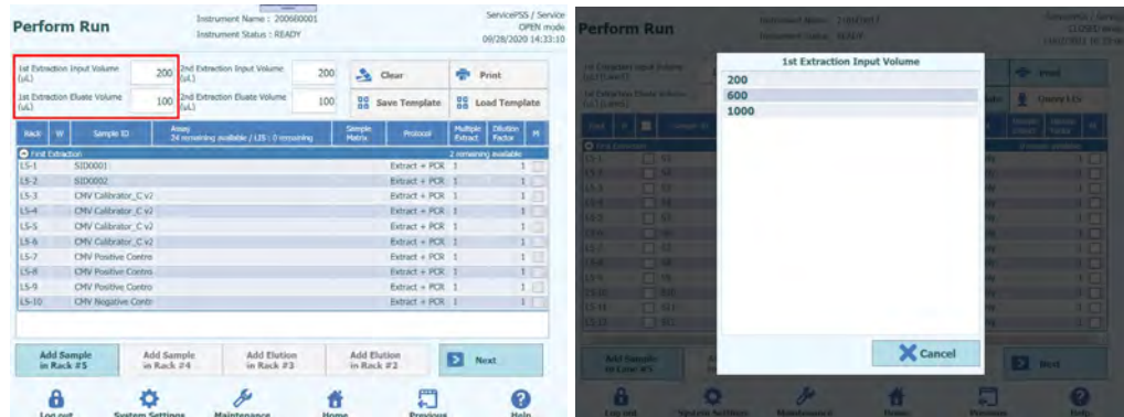
Figura 5-164: Seleção do volume de entrada da extração e do volume de eluição da extração
