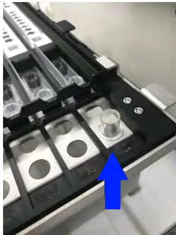
Figura 5-48: Instalação do tubo de extração no suporte de extração
