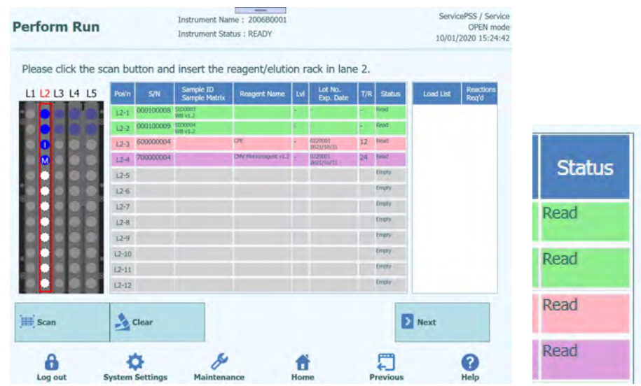
Figura 5-132: Estado de "Read" (Lido) para tubos de reagente com código de barras corretamente lido
