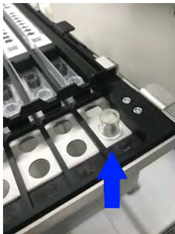
Figure 5-48 : Installation d'un tube d'extraction dans le portoir d'extraction.
