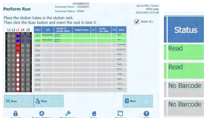
Figure 5-121 : Statut « No Barcode » (Absence de code-barres) lorsqu'aucune étiquette n'est apposée sur le tube de contrôle
