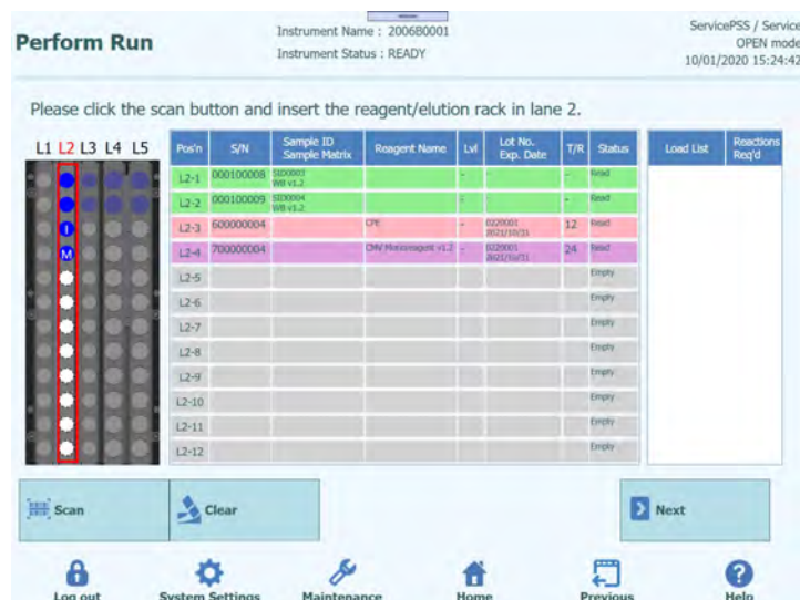
Figure 5-132 : Statut « Read » (Lu) pour des code-barres de tubes d'éluat lus avec succès
