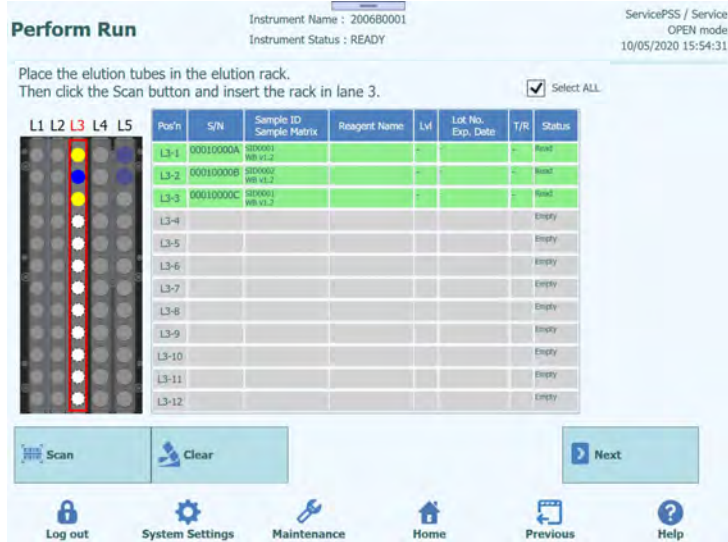
Figure 5-66 : Nombre de tubes d'éluats pour le même ID d'échantillon en cas de « Multiple Extract » (Extraction multiple)
