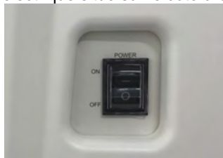
Figure 5-221 : Interrupteur d'alimentation électrique sur le côté droit de l'instrument
