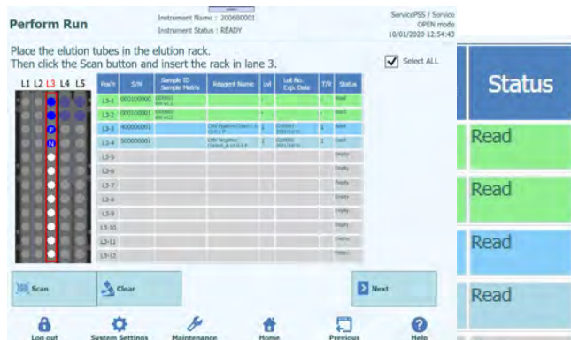
Figure 5-118 : Statut « Read » (Lu) lorsque le tube de contrôle a été lu avec succès
