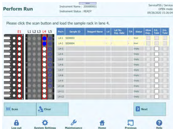
Figure 5-72 : Tubes d'échantillons scannés avec succès
