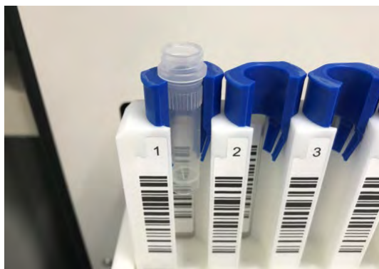
Figure 5-44 : Adaptateurs pour portoir d'échantillons
