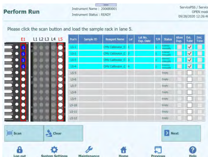
Figure 5-160 : Sélection d'un tube d'extraction en cas de réactif de calibrateur dans un tube d'extraction
