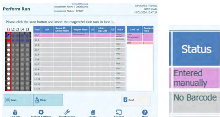
Figure 5-142 : Statut « Entered manually » (Saisi manuellement) lorsque les informations du réactif sont insérées manuellement
