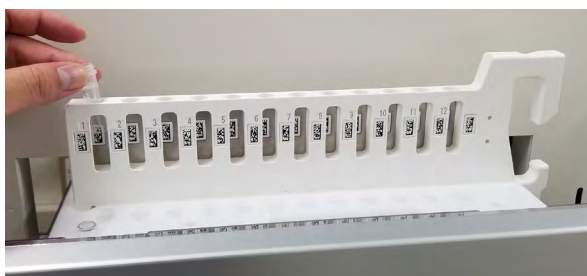
Figure 5-135 : Insertion d'un tube de réactif dans le portoir
