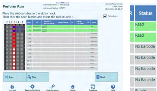
Figure 5-110 : Statut « No Barcode » (Absence de code-barres) lorsqu'aucune étiquette n'est apposée sur le tube de calibration
