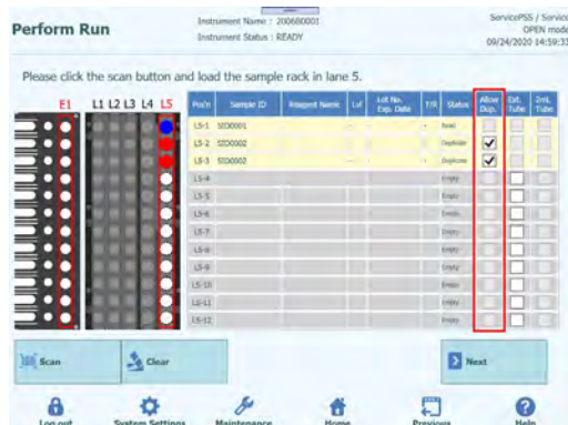
Figure 5-49 : Sélection de la fonction d'autorisation des doublons
