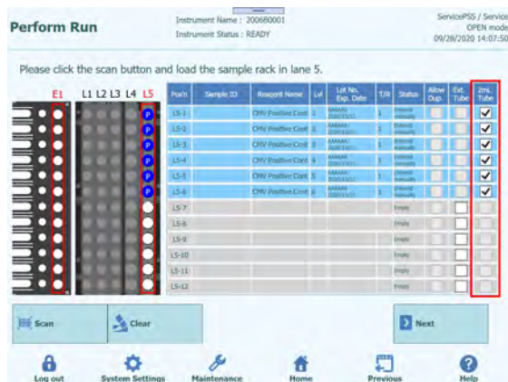
Figure 5-157 : Sélection de la case « 2 mL tube » en cas de tube de contrôle de 2 mL
