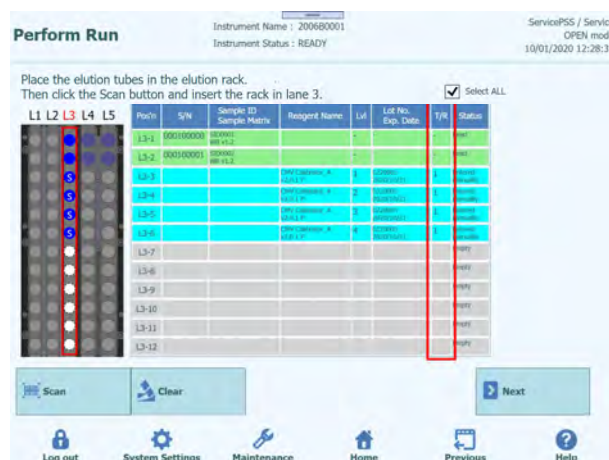
Figure 5-124 : Insertion du nombre de réactions pour le tube de réactif de contrôle
