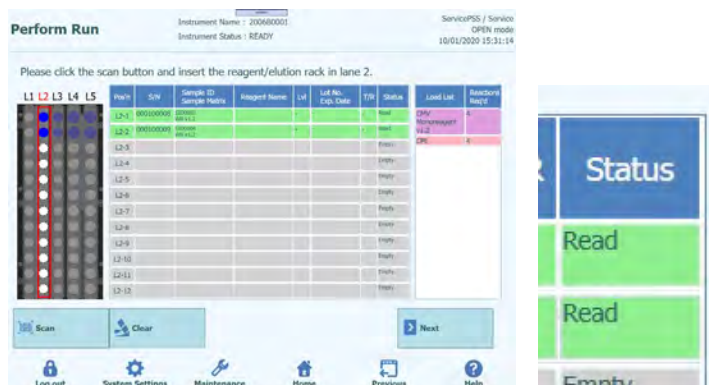
Figure 5-130 : Statut « Read » (Lu) pour un code-barres de tube d'éluat lu avec succès
