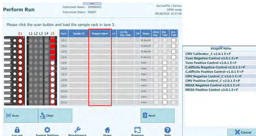
Figure 5-147 : Sélection du réactif à partir de la colonne « Reagent Name » (Nom du réactif)
