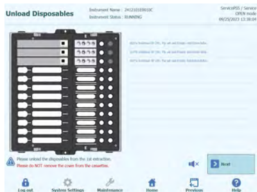
Figure 5-182 : Mise au rebut des cassette d'extraction, des kits d'embouts et des tubes d'extraction utilisés lors de la première extraction
