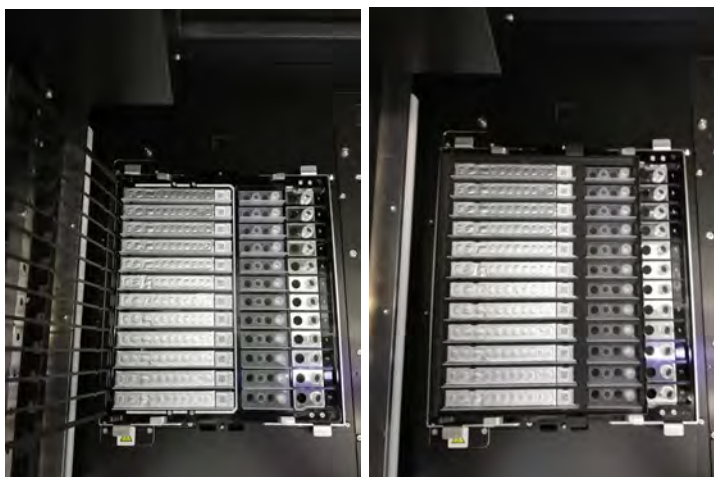
Figure 5-179 : Installation des cassettes d'extraction, des kits d'embouts et des tubes d'extraction vides sur le portoir d'extraction de l'instrument
