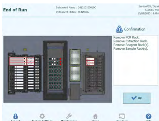
Figure 5-211 : Écran « End of Run » (Fin du cycle) avec des instructions sur le déchargement, le stockage ou l'élimination des échantillons, du matériel et des réactifs
