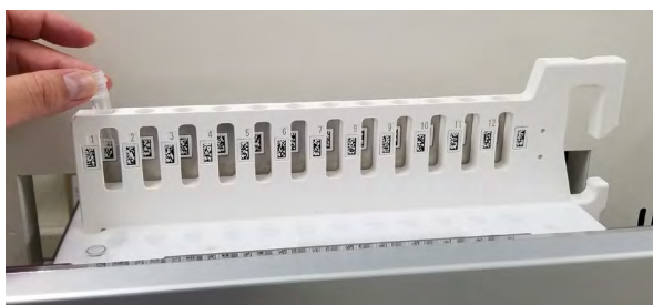
Figure 5-128 : Insertion d'un tube d'éluat vide dans le portoir
