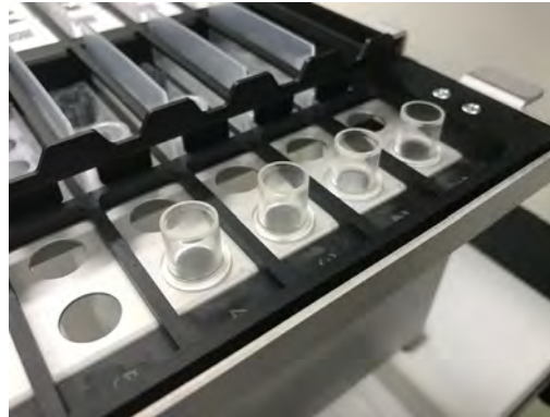
Figure 5-162 : Installation des tubes d'extraction dans le portoir d'extraction
