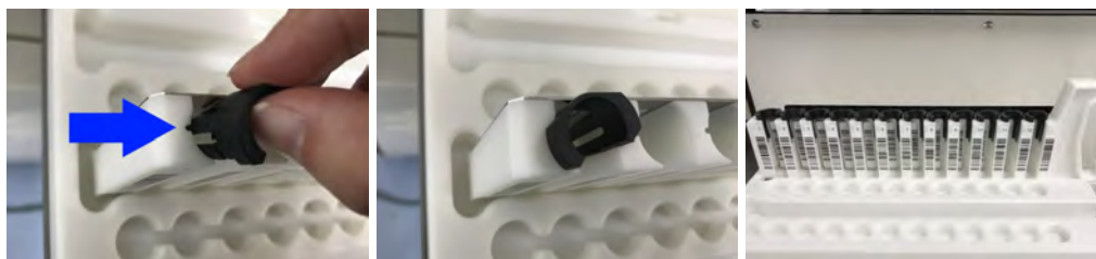
Figure 4-5 : Insertion des adaptateurs pour portoir d'échantillons dans le portoir ELITE BeGenius.
