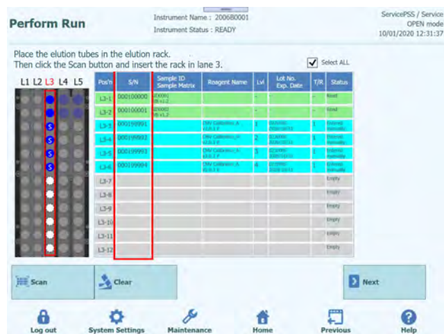
Figure 5-115 : Insertion du numéro de série pour le tube de réactif de calibrateur
