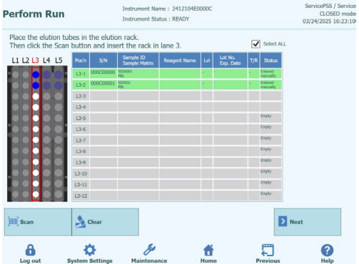
Figura 37: Rack per reagenti L3 caricato correttamente.
