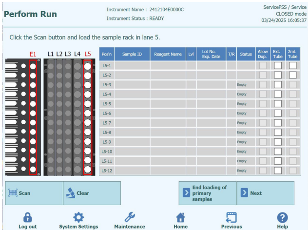
Figura 25: Eseguire il setup per il rack L5 .
