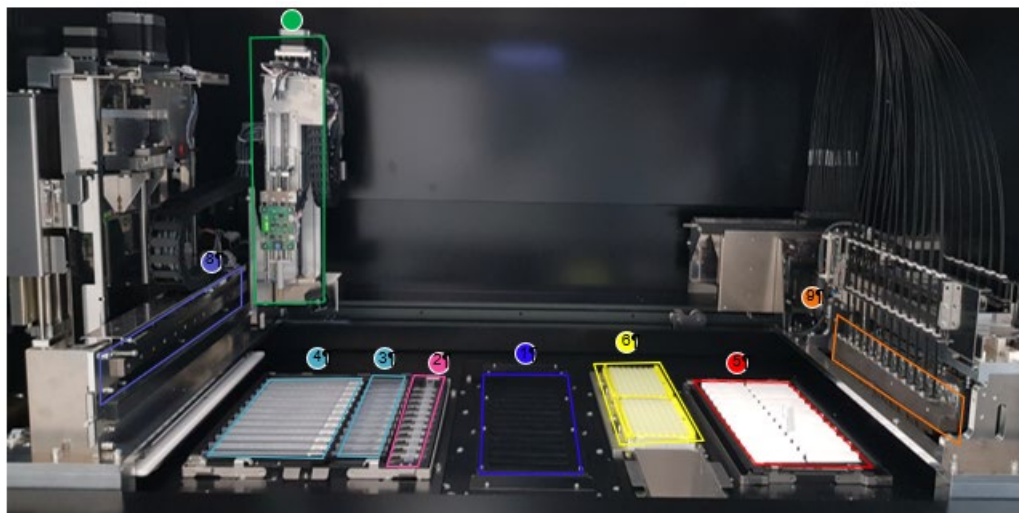
Figure 2 : Instrument ELITe BeGenius – Vue de la zone de travail
