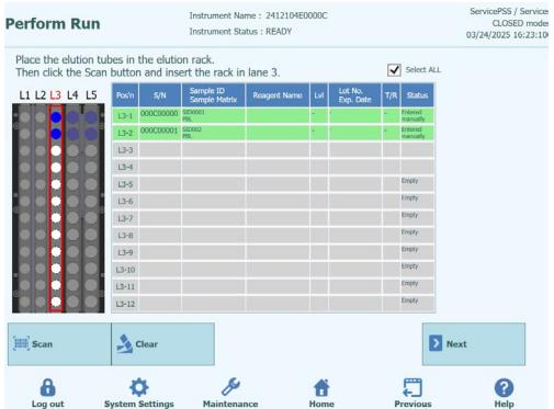
Figura 37: Rack de reactivos L3 correctamente cargado
