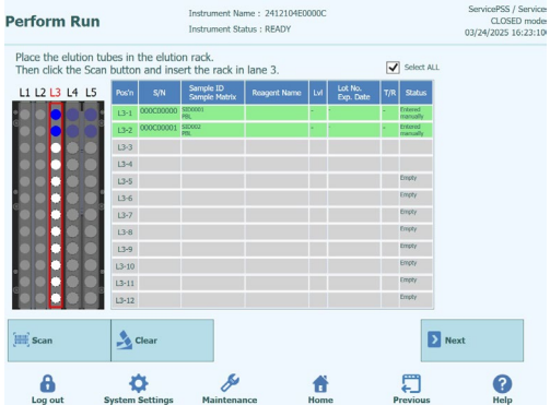
Figura 37: Rack de reactivos L3 correctamente cargado
