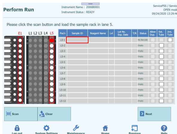
Figura 27: Código de barras del rack no leído
