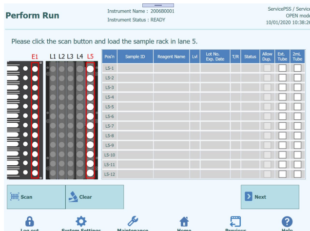
Abbildung 21: Einsetzen des Racks bei der Laufeinstellung
