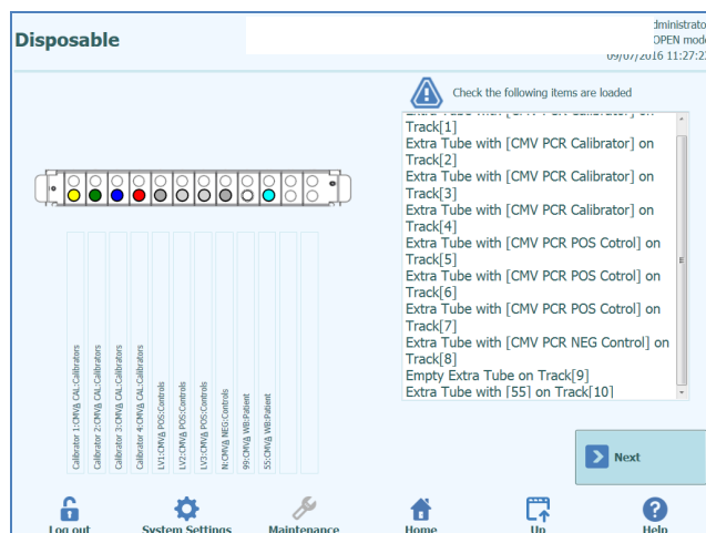
Figura 9: La schermata “Disposable” (Materiale Monouso) è usata per confermare il caricamento dell'Extra Tube Rack con i tubi di eluzione.
