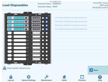
34. Retire o suporte de extração do instrumento, coloque o cartucho de extração de ácido nucleico, o conjunto de pontas e o tubo de extração vazio de acordo com a imagem da colocação; em seguida, instale o suporte de extração no instrumento.
