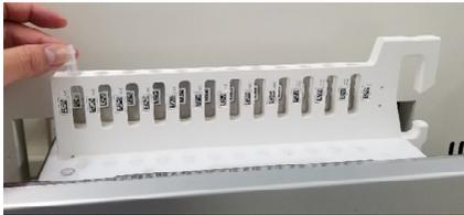
16. Insira cuidadosamente o Suporte de reagentes com o tubo de eluição instalado no L3 da Cooler Unit.
