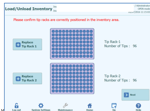
Figure 6: L'écran "Load / Unload Inventory" (Chargement / Déchargement d'inventaire) confirme le placement des embouts jetables (Tips).
