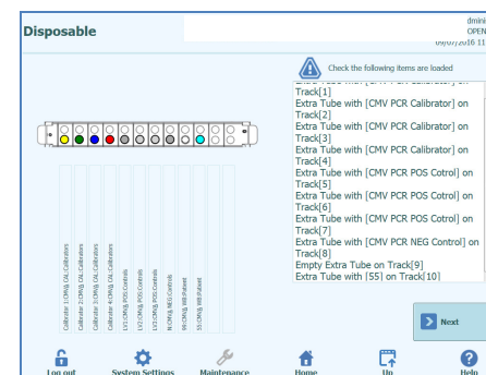
Figure 9: Ecran "Disposable" (Matériel Jetable) pour confirmer le chargement du rack Extra Tube avec les tubes d'éluatation.
