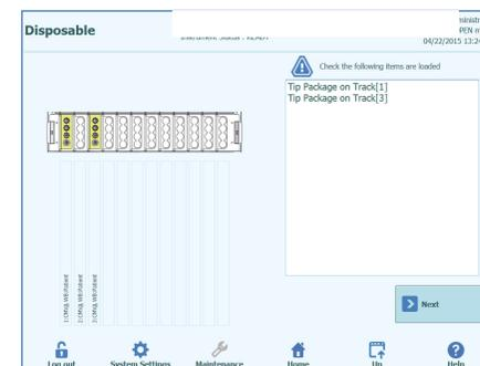
**Abbildung 10:** Der Bildschirm „Disposable“ (Einwegmaterialien) dient zur Bestätigung des Ladens von Spitzenständern
