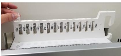
16. Setzen Sie das Reagenzienrack mit dem eingesetzten Eluatröhrchen vorsichtig in L3 der Kühleinheit ein.
