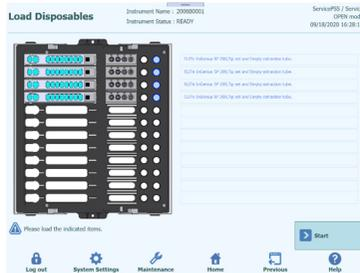
34. Nehmen Sie das Extraktionsrack aus dem Gerätegestell heraus, setzen Sie die Nukleinsäureextraktionskartusche, das Spitzenset und das leere Extraktionsröhrchen gemäß der Abbildung ein und laden Sie anschließend das Extraktionsrack in das Gerätegestell.
