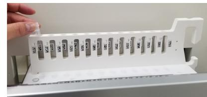
16. Inserire delicatamente il rack con la provetta eluato inserita nella L3 dell'unità di raffreddamento.
