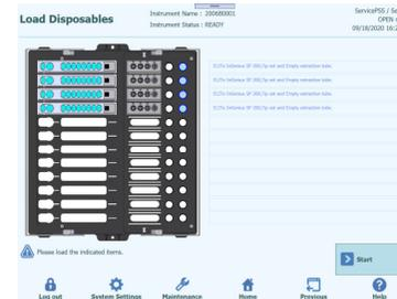
15. Rimuovere il rack per provette di estrazione dalla base dello strumento, applicare la cartuccia per l'estrazione degli acidi nucleici, il set di puntali e la provetta di estrazione vuota come mostrato dalla figura relativa al posizionamento, quindi applicare il rack per provette di estrazione alla base dello strumento.
