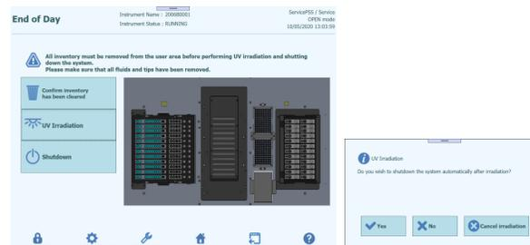
Selezionare 'Yes' (sì) per arrestare il sistema una volta completata la sterilizzazione UV. Se si seleziona 'No', il sistema non si arresterà una volta completata la sterilizzazione UV. Appare un messaggio di avviso per confermare che la lampada UV sia accesa. Seleziona "Sì" o "No" per confermare o no l'accensione della lampada UV. Se si seleziona 'Cancel irradiation' (annulla sterilizzazione), la sterilizzazione UV non è eseguita.
