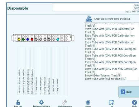
**Figura 9:** La schermata "Disposable" (Materiale Monouso) è usata per confermare il caricamento dell'Extra Tube Rack con i tubi di eluzione.
